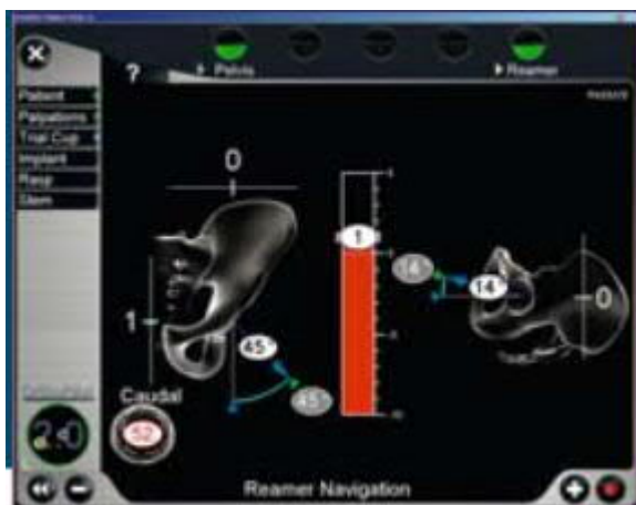
Abbildung 7: Navigation Pfannenkomponente mit Parametern (in Grad) für Inklination und Anteversion (© Aesculap AG)
