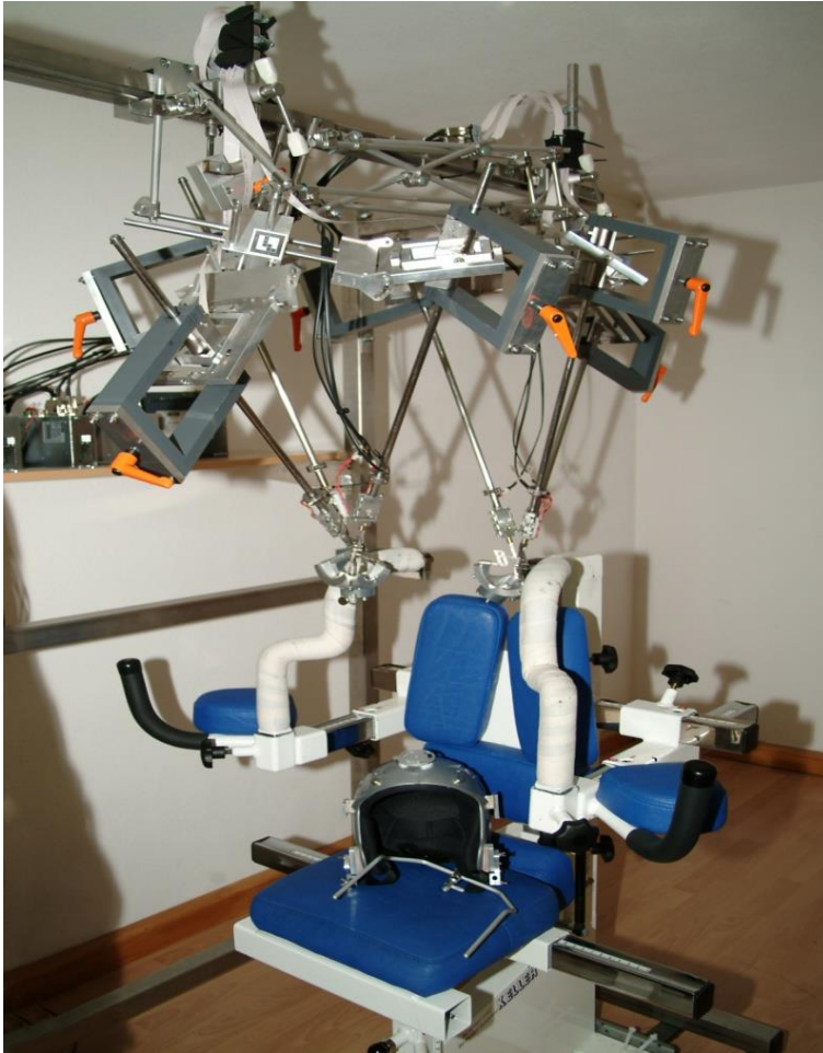
Abbildung 4: Parallelkinematische Robotik und Stuhl mit zwei Bügeln zur Fixation der Schulter
