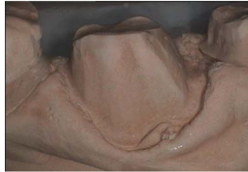
Abbildung 10 Fehlerart Perle am Gipsstumpf
