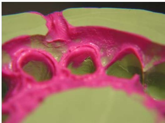
Abbildung 14 Fehlerart polymorphes Gebilde in einer Doppelmischabformung
